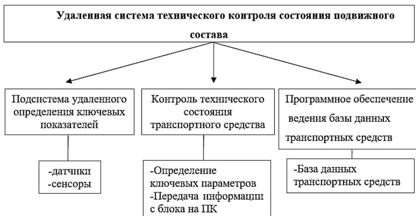
Рисунок 2 – Структурная схема удаленной системы контроля технического состояния подвижного состава
