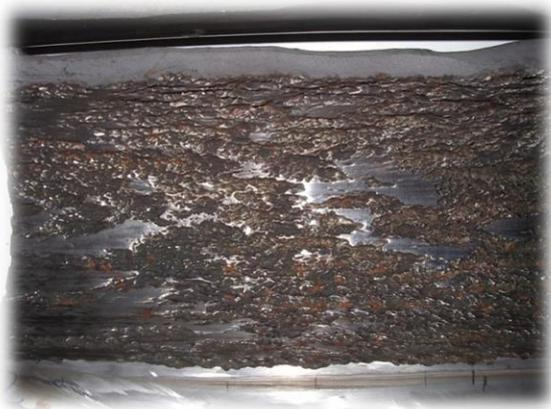
Рисунок 1 – Поверхность трубы ГИУ, подверженная высокотемпературному эрозионному изнашиванию
