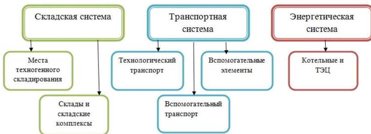
Рис. 2. Источники образования парниковых газов на горнодобывающих предприятиях
