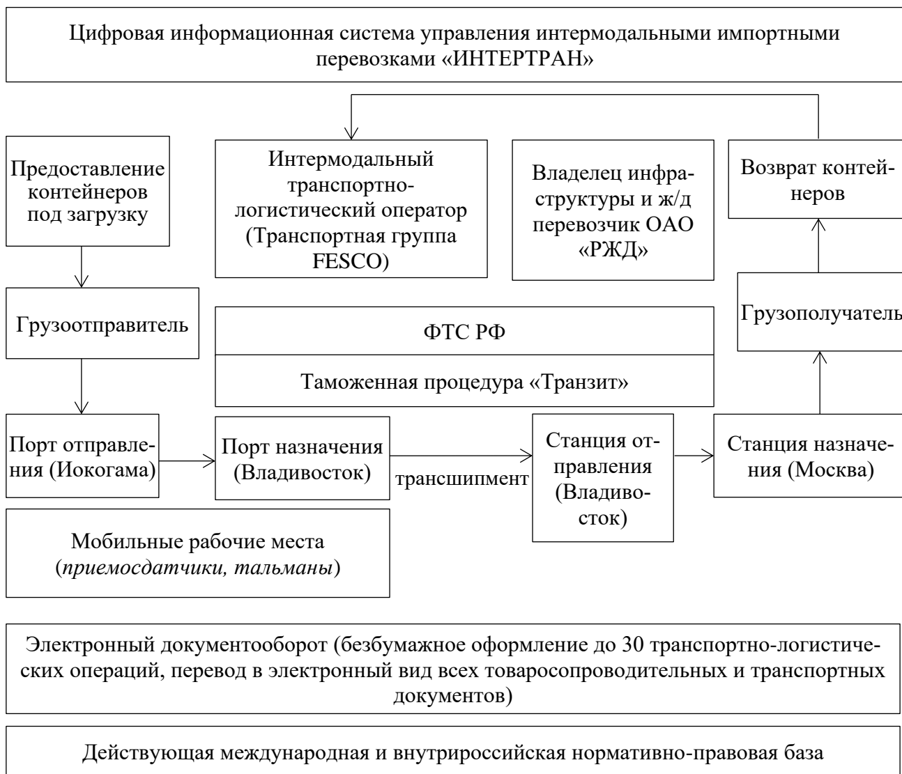
Рисунок 5.6 – Модель управления интермодальными импортными контейнерными перевозками на основе цифровой информационной системы «ИНТЕРТРАН» 84
