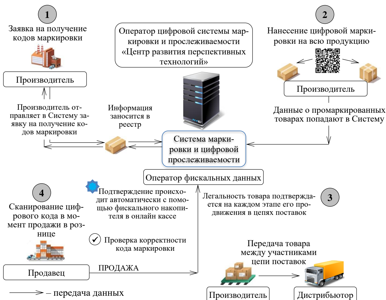
Рисунок 5.5 – Модель цифровой маркировки и прослеживаемости потоков в цифровых экосистемах транспортно-логистического обслуживания 83
