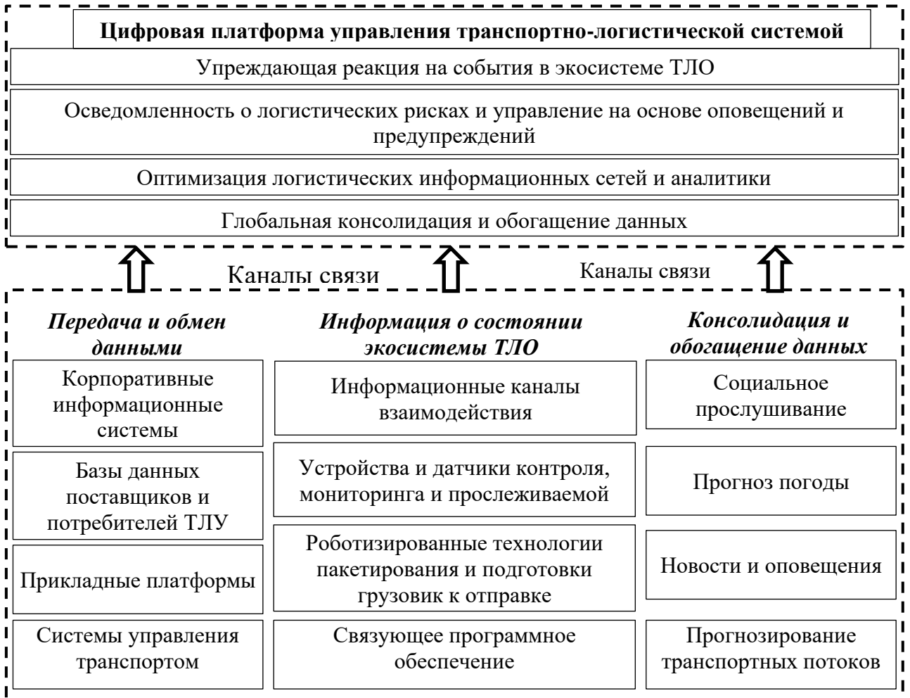
Рисунок 1.11 – Архитектура цифровой платформы экосистемы транспортно-логистического обслуживания 14
