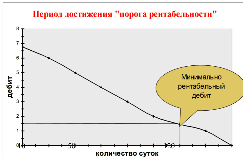
Рис. 18. Графическое определение порога рентабельности скважины
