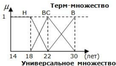
Рисунок 13. График ФП ЛП "Возраст потенциального заемщика от 14 до 30 лет включительно", построенной на основе экспертной оценки
