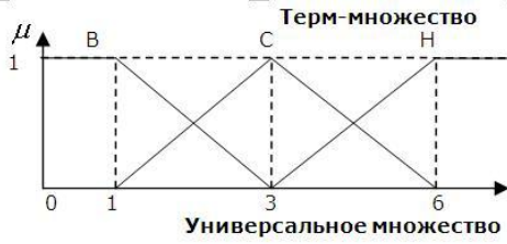
Рисунок 179. График функции принадлежности лингвистической переменной "Повышение уровня образования (сколько лет назад)", построенный на основе экспертной оценки
