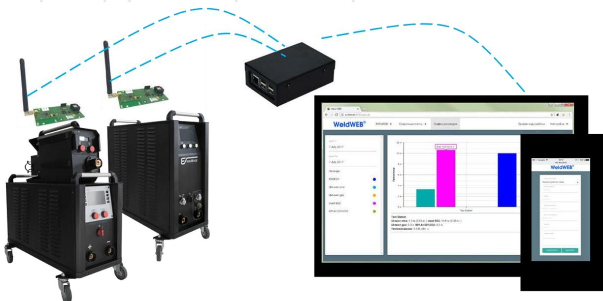
Рисунок 26 – Цифровое управление и контроль режимов сварщиков
