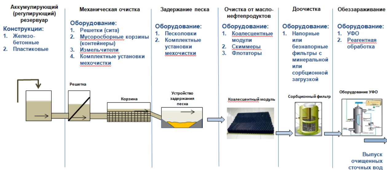
Рис. 82. Современная технологическая схема очистки поверхностных сточных вод, применяемая на предприятии ГУП «Водоканал Санкт-Петербурга»
