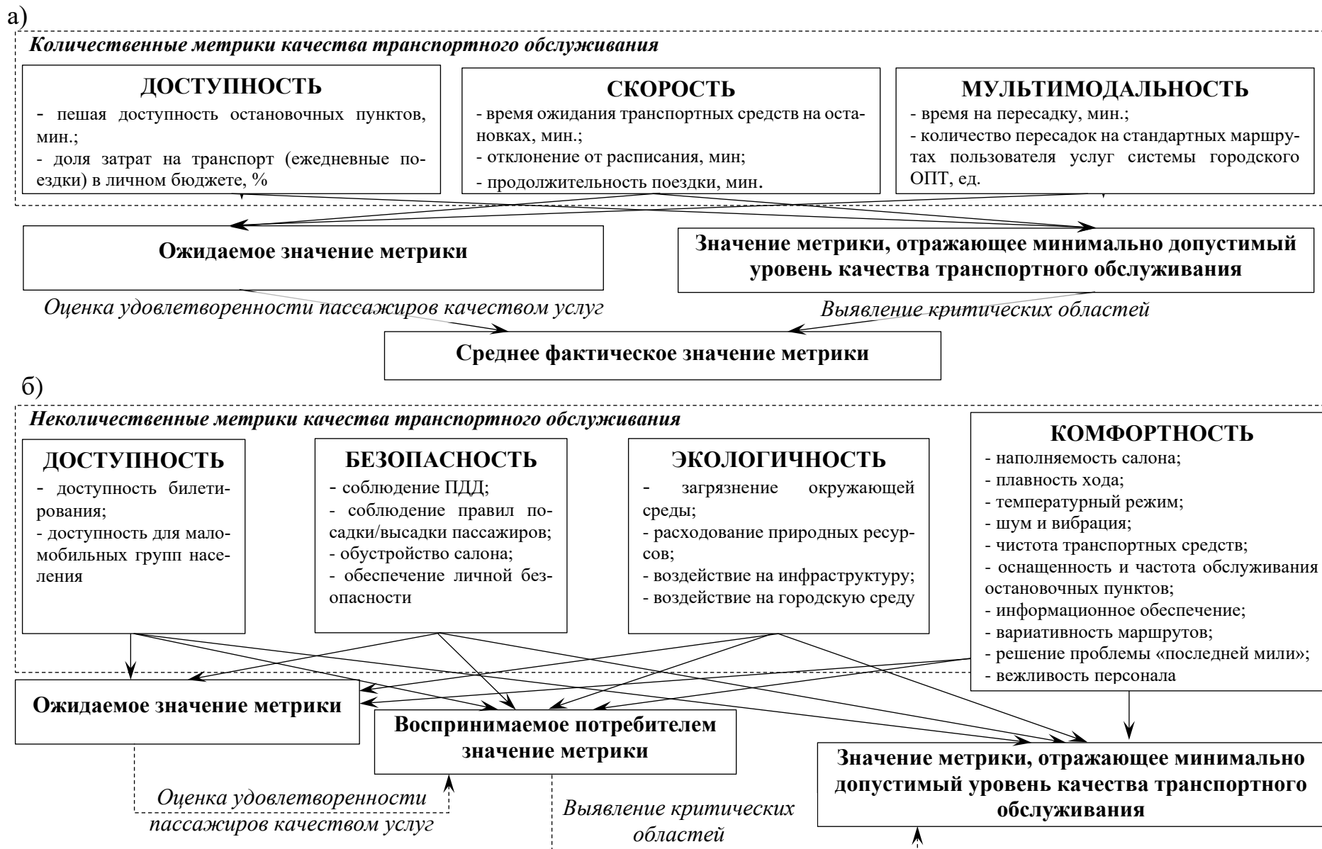
Рисунок 2.5 – Структура модели оценки пассажирами качества услуг городского пассажирского транспорта с использованием количественных (а) и неколичественных (б) метрик
