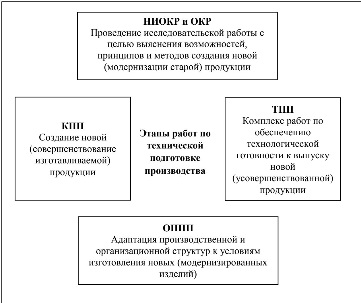
Рис. 1. Состав работ по технической подготовке производства
