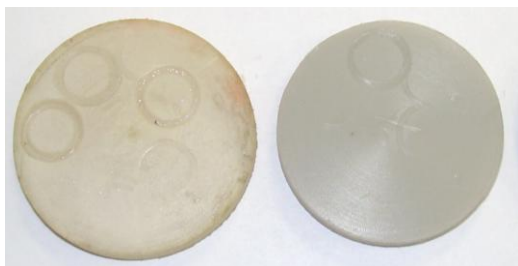
РИС.1. ОБРАЗЦЫ ДЛЯ ТРИБОМЕТРИЧЕСКИХ ИСПЫТАНИЙ
