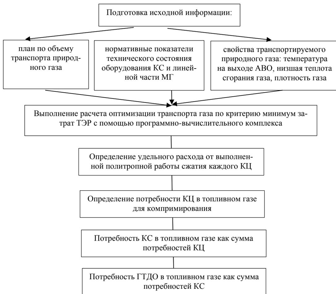
Рисунок 4 – Порядок нормирования расхода топливного газа на компримирование
