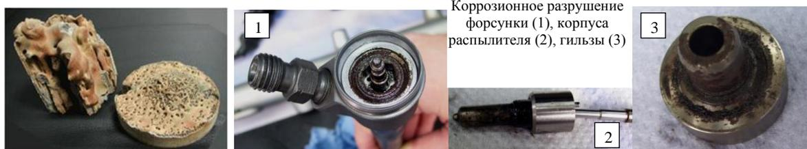
Рисунок 2 – Состояние блоков-носителей при нештатных режимах работы ТКС
