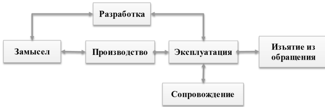
Рисунок 4 – Модели жизненного цикла: типовая схема с различными способами прохождения стадий [1]
