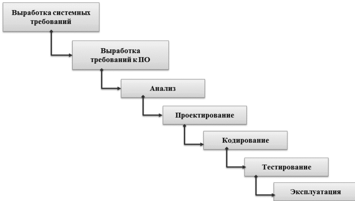
Рисунок 1 – Цикл разработки ИС согласно классической каскадной модели ЖЦ [2]
