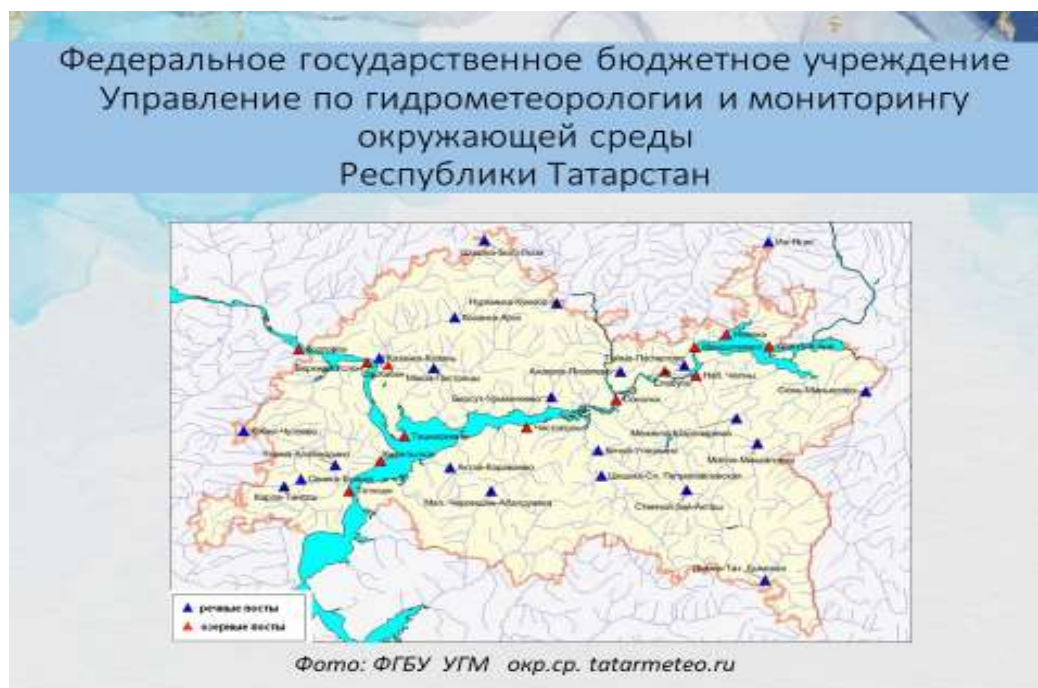
Рисунок 4 – Речные и озерные гидрологические посты изучение гидрологического режима водохранилища
