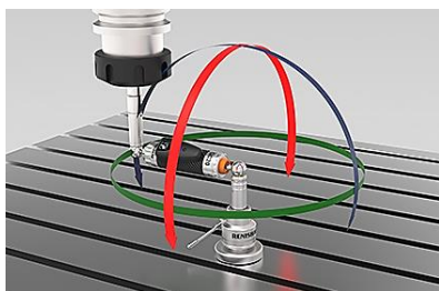
Рисунок 2 – Система QC20-W Ballbar в процессе отработки
