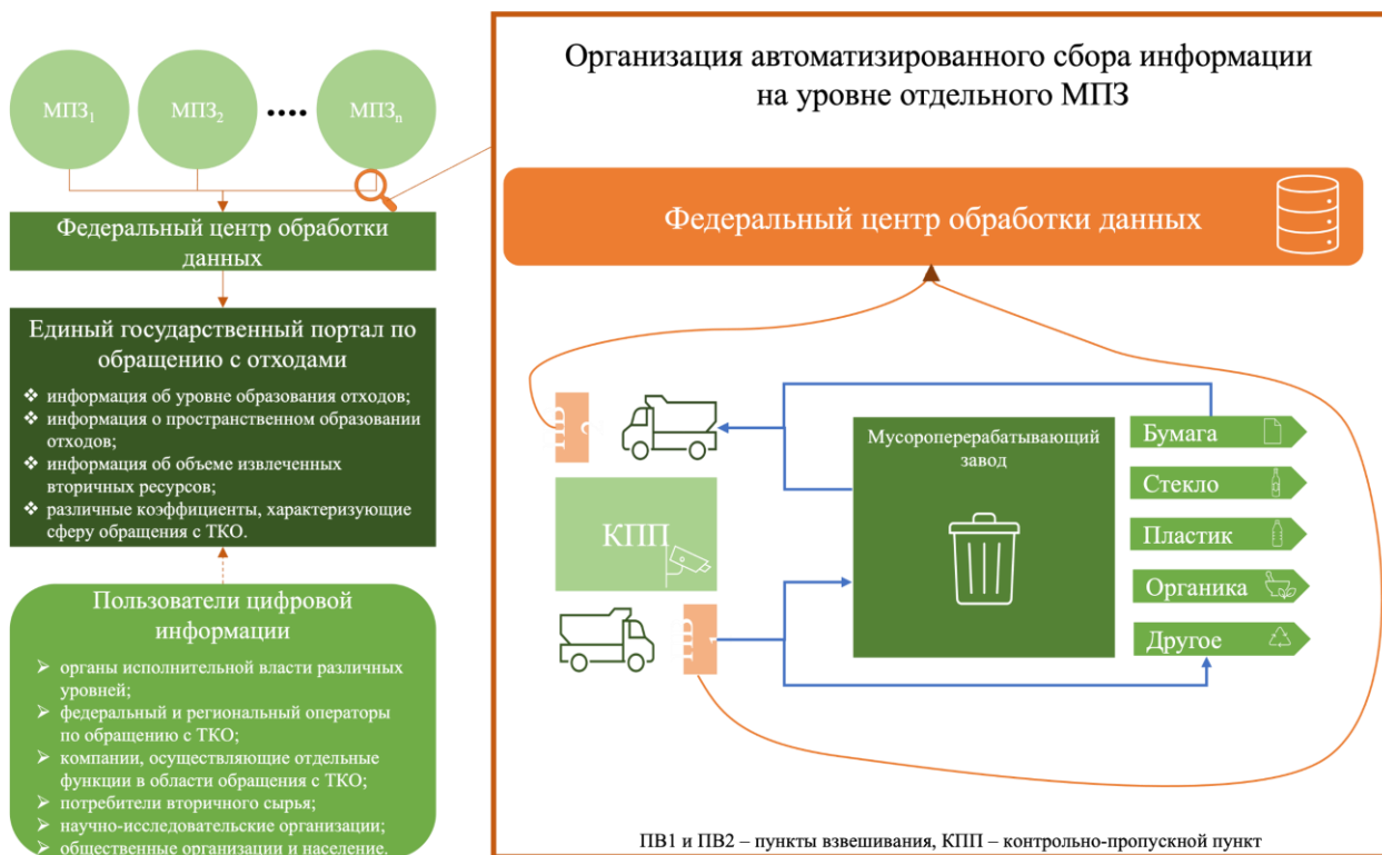
Рисунок 16 – Автоматизированная система сбора данных о ТКО [составлено автором]
