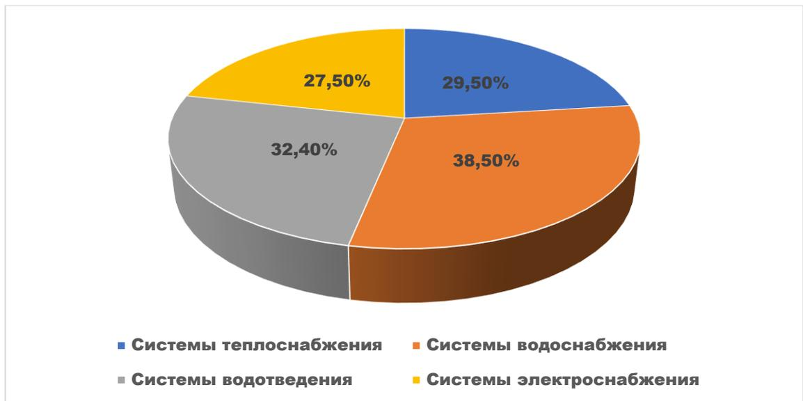
Рисунок 1.9 - Данные по степени износа в некоторых системах и структурных элементах инженерно-энергетического комплекса г. Санкт-Петербурга по состоянию на 2022 г. [составлено автором по материалам [13; 135]]
