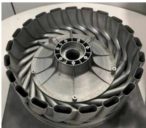
Рисунок 3. Рабочее колесо насоса, изготовленное на предприятии в Росатоме при помощи аддитивных технологий [11]
