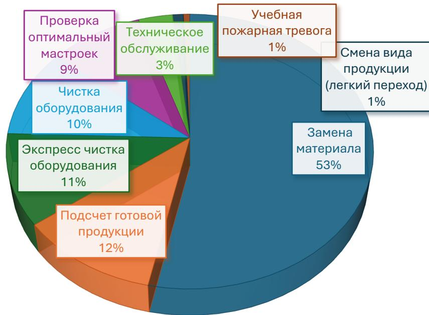
Рисунок 2.5 - Распределение плановых остановок поточной производственной линии по причинам за месяц, в процентах
