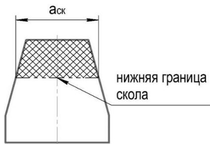
Рисунок 3 – Схема измерения сегментного образца после испытания
