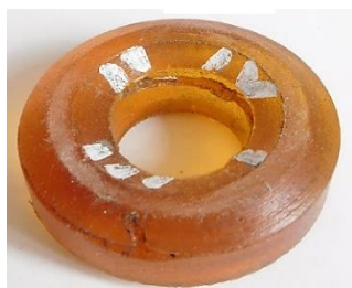
Рисунок 6 – Следы разрушения (прокола) подушки острыми кромками: а) – Подушка обтюраторная с металлическими кольцами; б) – подушка обтюраторная отдельно
