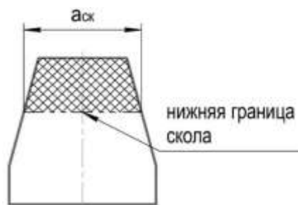
Рисунок 3 – Схема измерения сегментного образца после испытания
