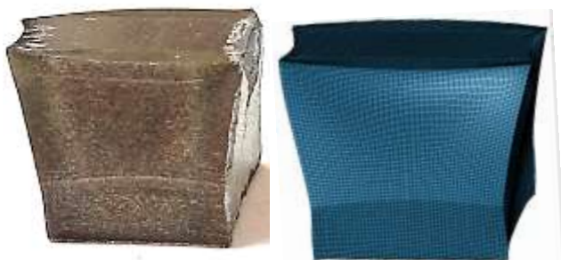
Рисунок 6 – Фотография и результат численной симуляции при одноосном сжатии образца 4 (покрытие располагается справа)
