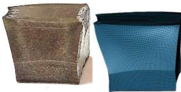
Рисунок 7 – Фотография и результат численной симуляции при скомпенсированном нагружении образца 4 (покрытие располагается справа)
