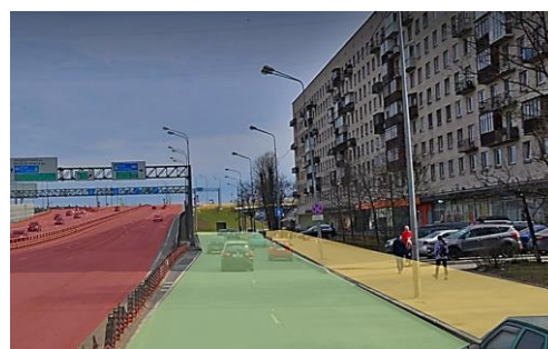
Рисунок 4 – Зонирование дорожно-транспортной инфраструктуры по разрешенным и запрещенным маршрутам следования
