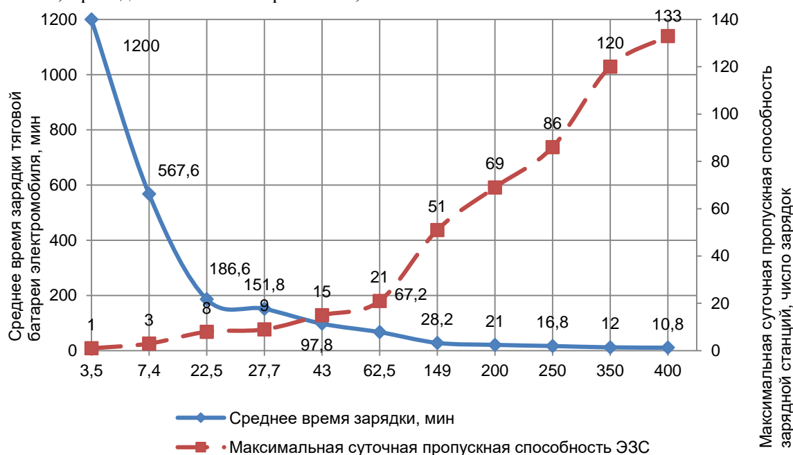
Рисунок 6 – Графические зависимости среднего времени пребывания электромобиля на ЭЗС во время зарядки тяговой батареи и максимальной суточной пропускной способности зарядных станций от их мощности
