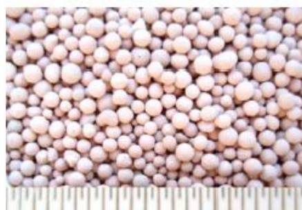
Рисунок 1 – Вид загрузки сорбционных фильтров (минеральная и керамическая)
