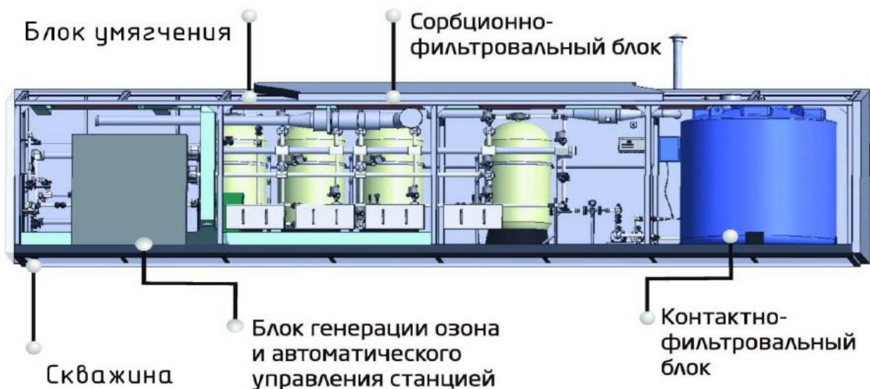
Рисунок 2 – Технологическое решение по очистке водных ресурсов на основе сорбционной технологии
