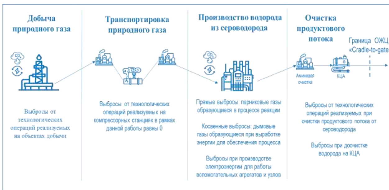
Рис. 4. Области образования выбросов парниковых газов при производстве водорода
