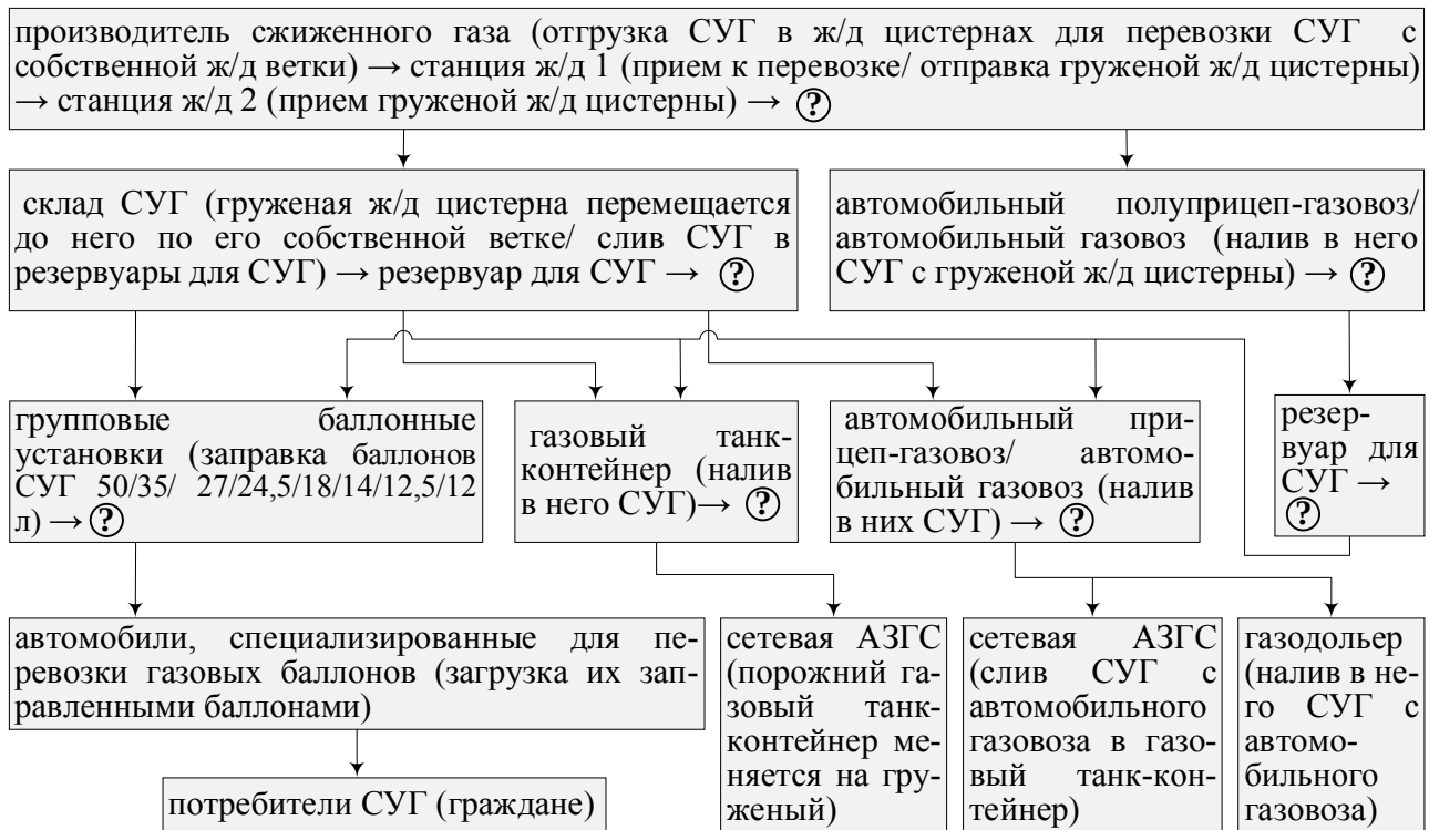
Рисунок 2 - Конфигурации цепей поставок СУГ для АЗГС и коммунально-бытовых нужд граждан РФ (по схеме отгрузки производителем СУГ готовой продукции в ж/д цистернах)
