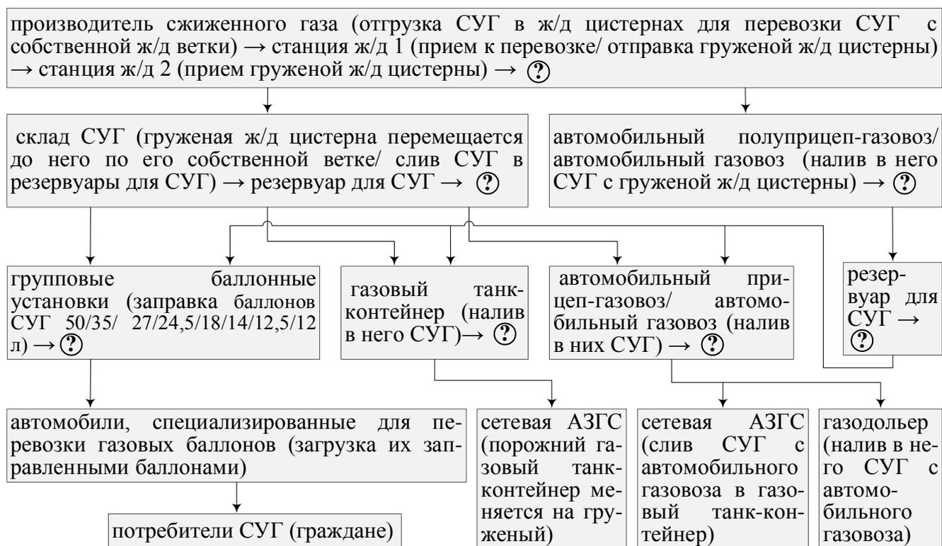
Рисунок 2.26 - Конфигурации цепей поставок СУГ для АЗГС и коммунально-бытовых нужд граждан РФ (по схеме отгрузки производителем СУГ готовой продукции в ж/д цистернах
