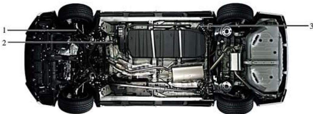
Рисунок 1 – Компоненты нижней части автомобиля (днище кузова): 1 – Передний узел подвески; 2 – элементы гидравлической тормозной, топливной магистрали; 3 – Горловинный патрубок топливного бака
