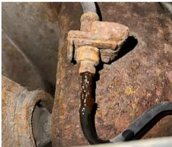
Рисунок 3 – Коррозионное разрушение тормозной линии
