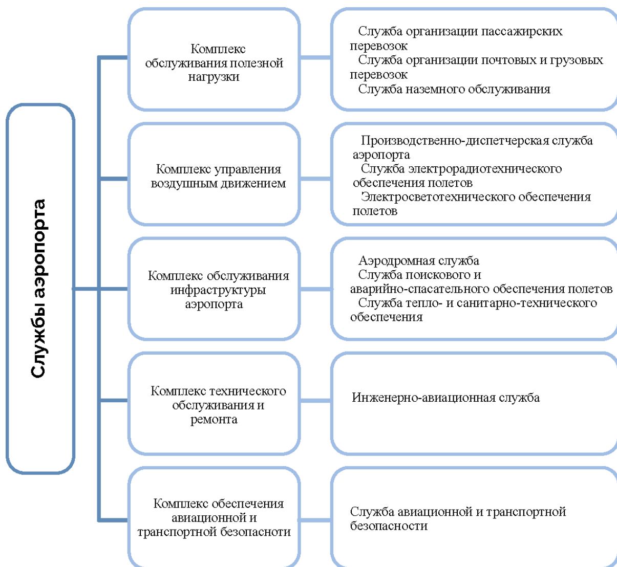
Рисунок 1.2.2 – Структура технических служб аэропорта (составлено по [178, С. 15])
