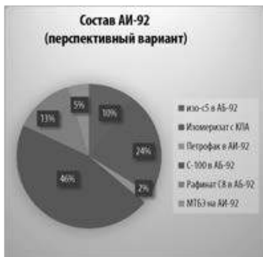
Рисунок 2 — Состав АИ-92 в базовом и перспективном вариантах
