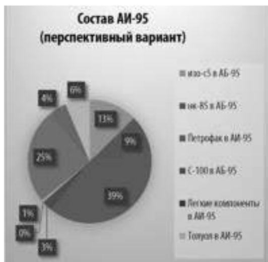
Рисунок 3 — Состав АИ-95 в базовом и перспективном вариантах
