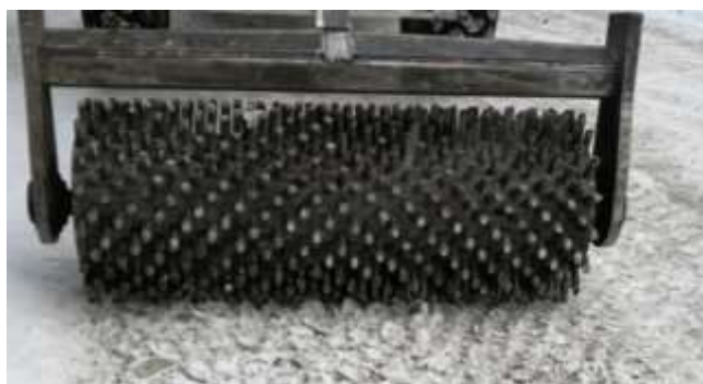
Рисунок 2 – Внешний вид льдоскалывающего вальца
