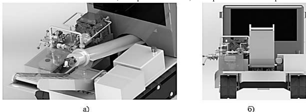
Рисунок 4 – Местоположение ДВС и гидронасоса - (а), вид гусеничный движитель в транспортном положении - (б).
