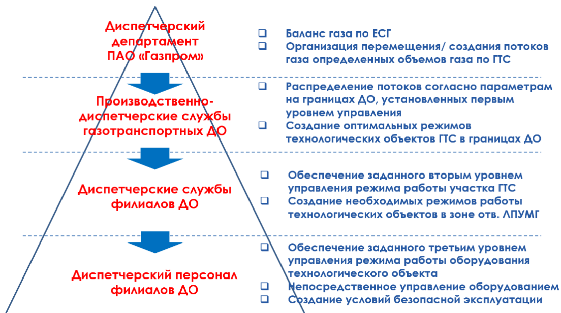
Рисунок 7. Четырехуровневая иерархическая система диспетчерского управления ГТС
