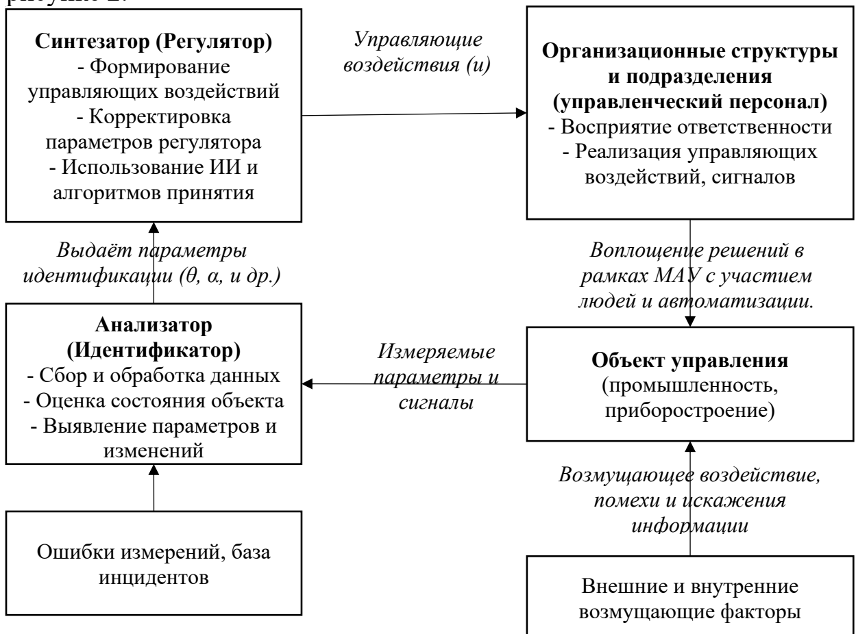
Рисунок 2. Многоуровневая динамическая система управления с МАУ на основе работы функционально-адаптивной системы автоматического управления
