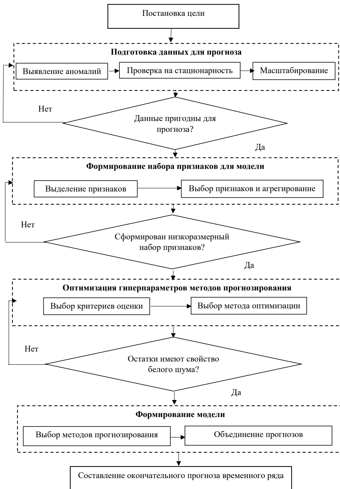
Рисунок 4.39 – Алгоритм выбора модели прогнозирования с использованием методов искусственного интеллекта
