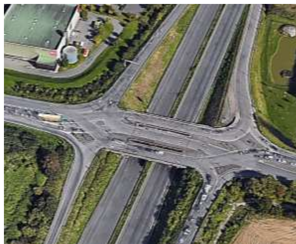
Рисунок 2 – Ромбовидный перекресток со сменной сторонности
